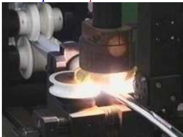
Рис.2.4.2.р.1 TIG сварка алюминия
