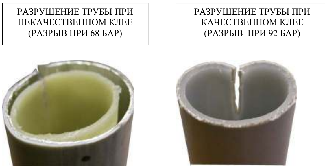
Рис.2.3.4.р.2 Вид среза МПТ после разрывных испытаний
